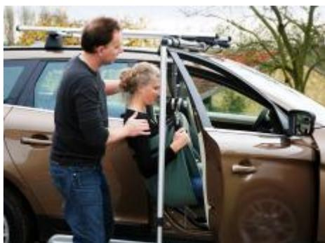
**Montacarichi** - sono di solito montati sull'auto per aiutare a sollevare qualcuno dentro e fuori, ma necessita di molto tempo rispetto ad altri dispositivi. Gli elevatori potrebbero non essere adatti a tutti i bambini. Un bambino che è soggetto a spasmi sarà difficile da sollevare in modo sicuro e l'imbracatura può causare danni alla pelle attraverso la tranciatura.
